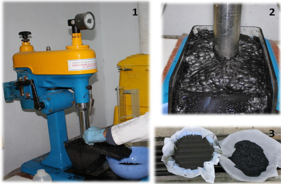
Şekil 1. Denver flotasyon hücresi (1), flotasyon anı (2) ve filtrasyon işlemi (3)
