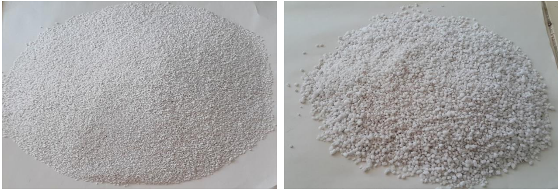
Şekil 1. Genleştirilmiş perlit numuneleri
