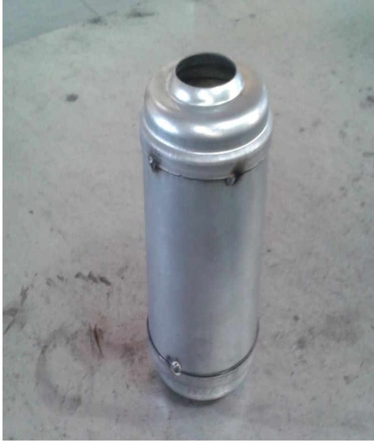
Şekil 6. Filtre malzemesi doldurulan filtrenin iki ucunun kapakla kapatılması
