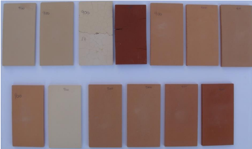
Şekil 17. 900°C'de Fırınlanan Tabletlerin Toplu Görüntüsü
