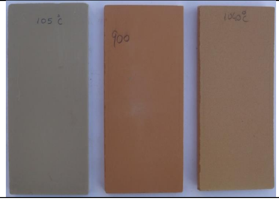
Şekil 10. Eğrcy Örneğinden Elde Edilen Ham ve Fırınlanmış Tabletler
