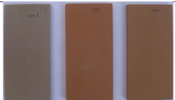
Şekil 12. Smst-2 Örneğinden Elde Edilen Ham ve Fırınlanmış Tabletler
