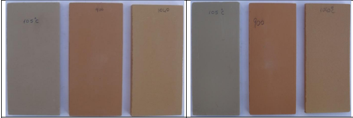
Şekil 9. Kht-1 Örneğinden Elde Edilen Ham ve Fırınlanmış Tabletler
