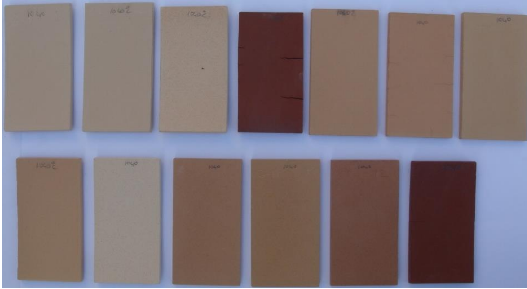
Şekil 18. 1040°C'de Fırınlanan Tabletlerin Toplu Görüntüsü
