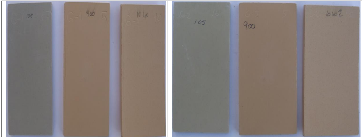
Şekil 3. Bsn-1 Örneğinden Elde Edilen Ham ve Fırınlanmış Tabletler
