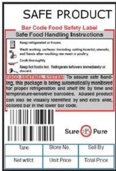
Resim 3. Food Sentinel System™ (FSS) biyosensör etiket (Han, J. 2000)
