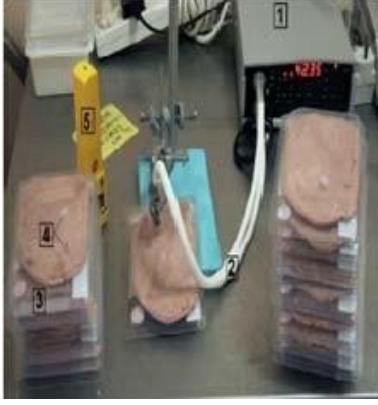
Resim 1. Gaz sensörü (Han, J. 2000) Resim 2. Optik oksijen sensörleri (Ahvenainen, R., 2003)
