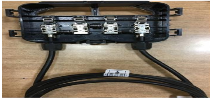
Resim 3.7 Bağlantı Kutusu (junction box)
