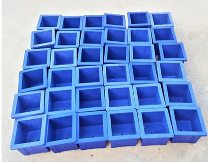
Resim 4.1 Çalışmada kullanılan küp kalıplar
