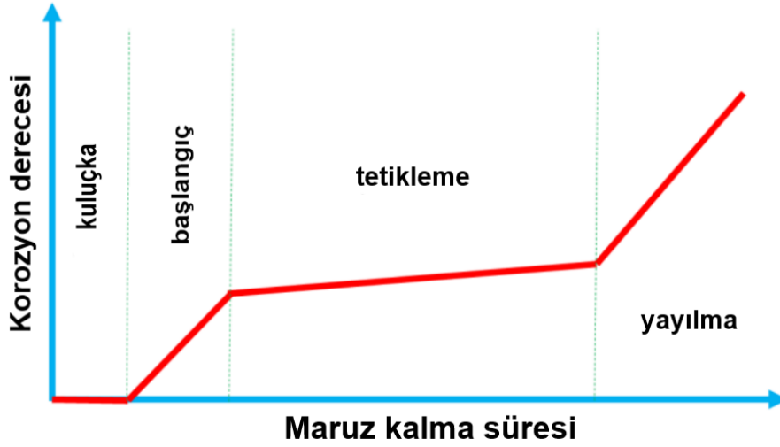
Şekil 2.1 Donatı korozyonu evrimi [1]
