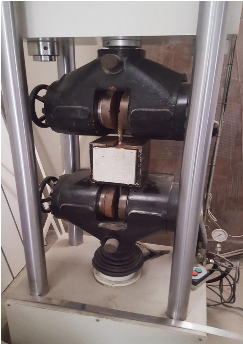
Resim 4.8 Çekme-çıkarma deney düzeneđi
