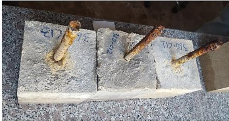
Resim 4.10 28, 180 ve 360 gün sonunda donatıda meydana gelen korozyon
