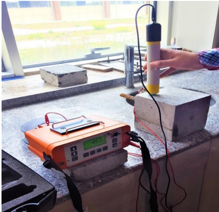
Resim 4.9 Numunenin yarı hücre potansiyeli ölçümü
