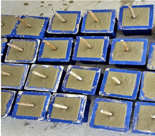
Resim 4.4 Betona gömülü çelik donatı
