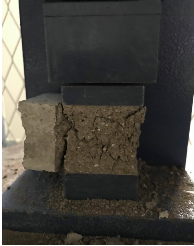
Resim 5.2 Basınç dayanımı uygulaması
