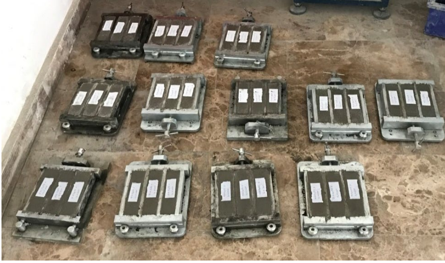
Resim 4.5 Kalıplara yerleştirilen numuneler
