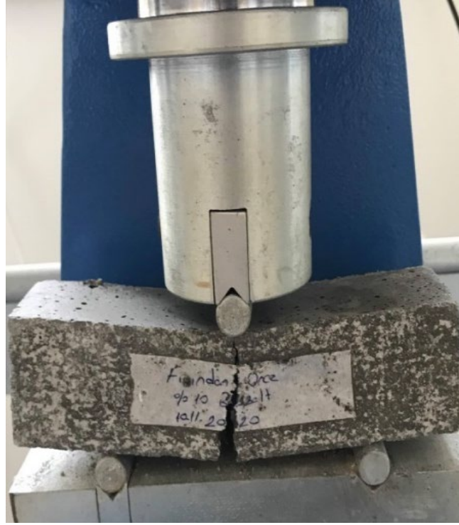
Resim 5.1 Eğilme dayanımı uygulaması
