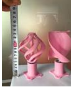
Resim 3.9 Helisel darrieus model dikey eksenli MRT
