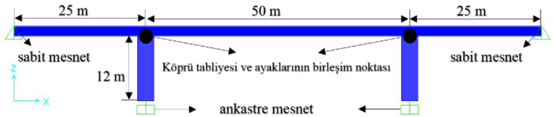
Şekil 3.6 Köprü modelinin x-z ekseninde görüntüsü, mesnet türleri ve eleman uzunlukları
