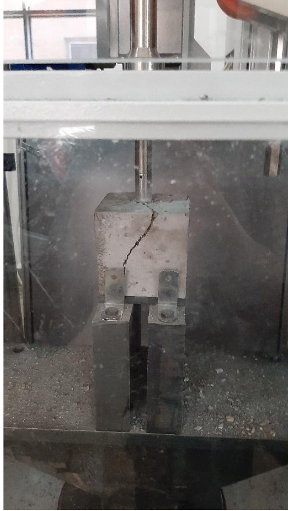
Resim 6.24 Küresel uç ile küp numuneye aletli ağırlık düşürme
