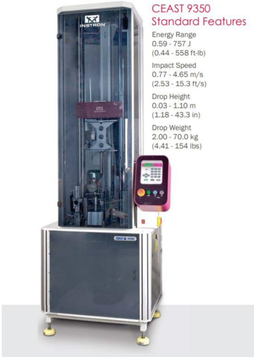
Resim 5.1 Deneyde kullanılan aletli ağırlık düşürme test cihazı [18]
