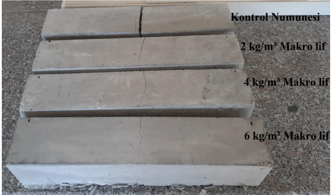
Resim 7.2 Polipropilen lif ilaveli ve kontrol, kiriş numunesinin üç nokta yükleme deneyi sonrasındaki durumu
