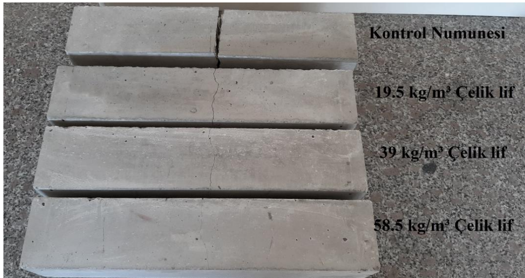
Resim 7.1 Çelik lif ilaveli ve kontrol, kiriş numunesinin üç nokta yükleme deneyi sonrasındaki durumu
