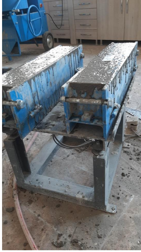
Resim 6.20 Kiriş numunesinin vibrasyon masasında sıkıştırılması
