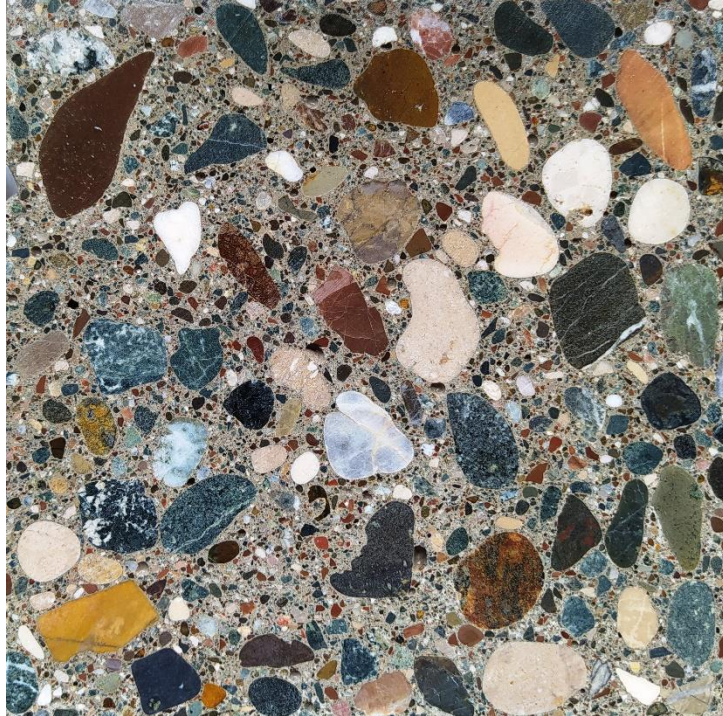
Resim 5.3 P.4 beton örneğinin makroyapısı
