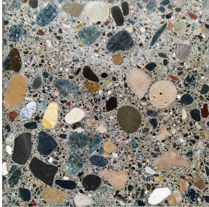
Resim 5.4 P.5-P.6 beton örneklerin makroyapısı
