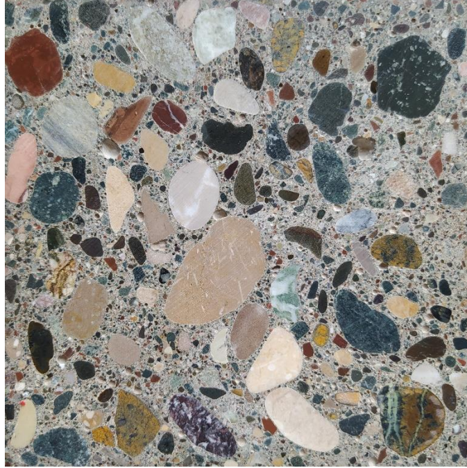
Resim 5.1 E.1-E.2 beton örneklerin makroyapısı
