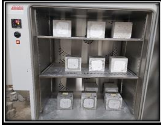
Resim 4.11 75 °C sıcaklıktaki etüvde bekletilen beton örnekleri
