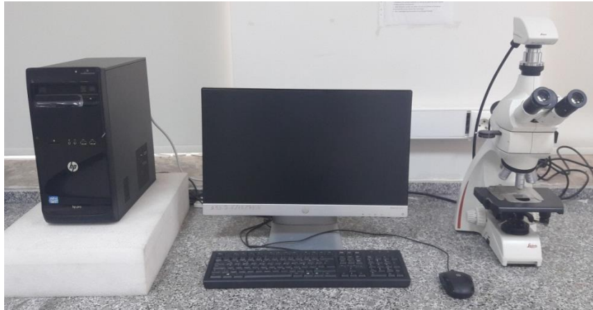
Şekil 3.7 Metalografik incelemelerde kullanılan optik mikroskop
