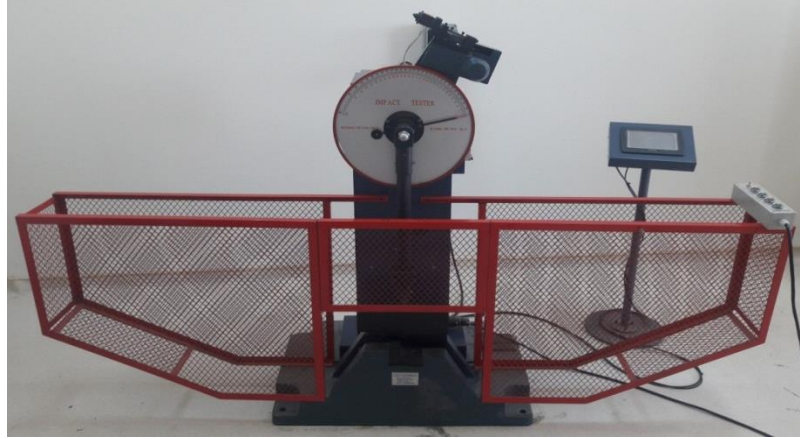
Şekil 3.16 Çentik darbe deney makinesi
