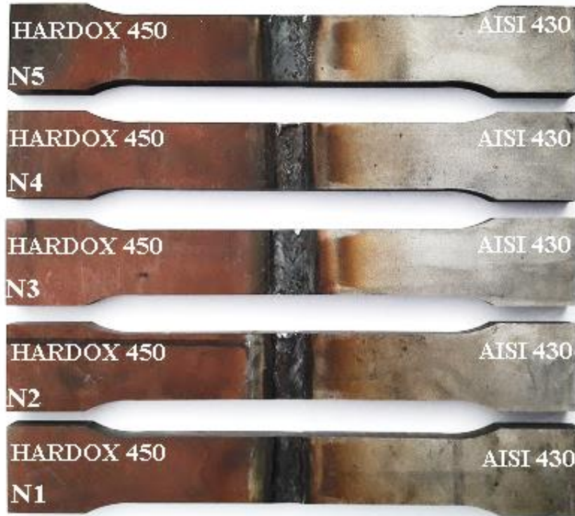
Şekil 4.119 Ara tabakasız numunelerin çekme deneyi öncesi makro görünüşleri
