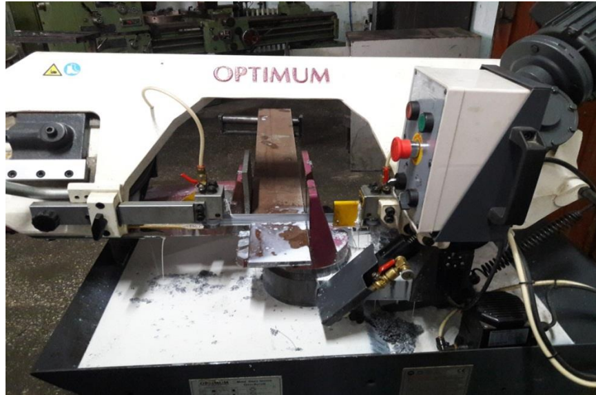
Şekil 3.1 Kaynak numuneleri kesme işlemi
