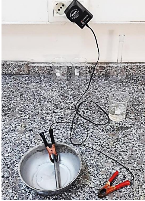
Şekil 3.6 Elektrolitik dağlama ünitesi
