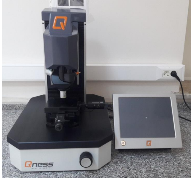
Şekil 3.10 Mikrosertlik ölçüm cihazı
