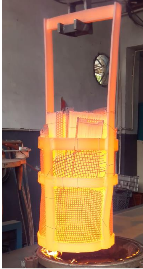
Şekil 1.20 Martenzitik paslanmaz çeliğin ısı işlemi
