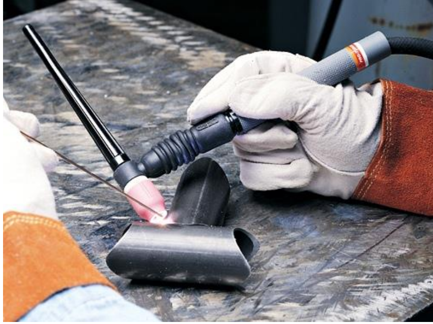
Şekil 1.14 TIG kaynak işlemi [13]
