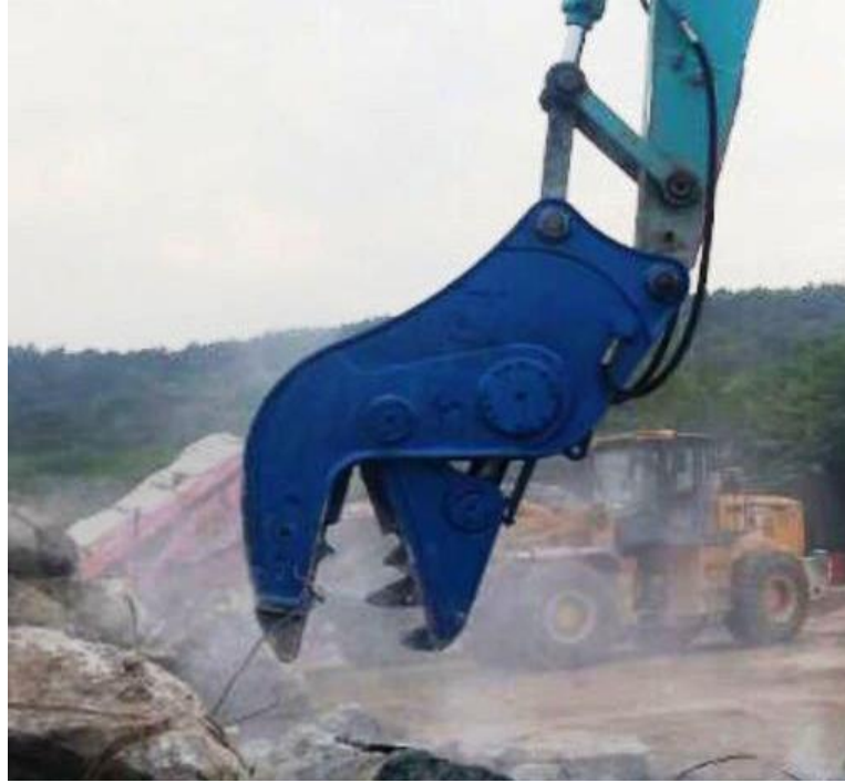
Şekil 1.24 HARDOX çeliğinden imal edilmiş bir kırıcı [10]
