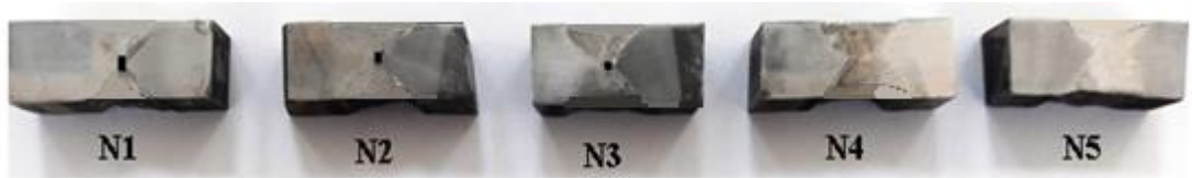
Şekil 4.2 Ara tabakasız numunelerin arakesit alınmış makroyapı görüntüleri
