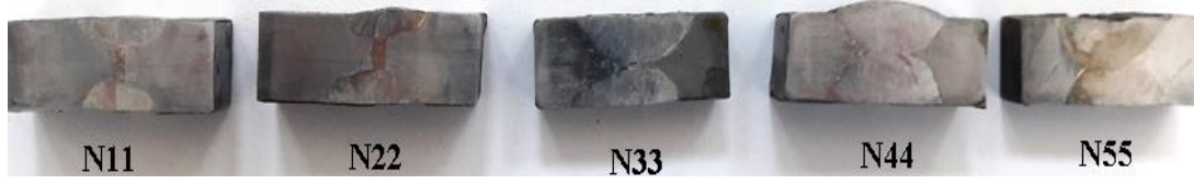
Şekil 4.4 Ara tabakalı numunelerin arakesit alınmış makroyapı görüntüleri
