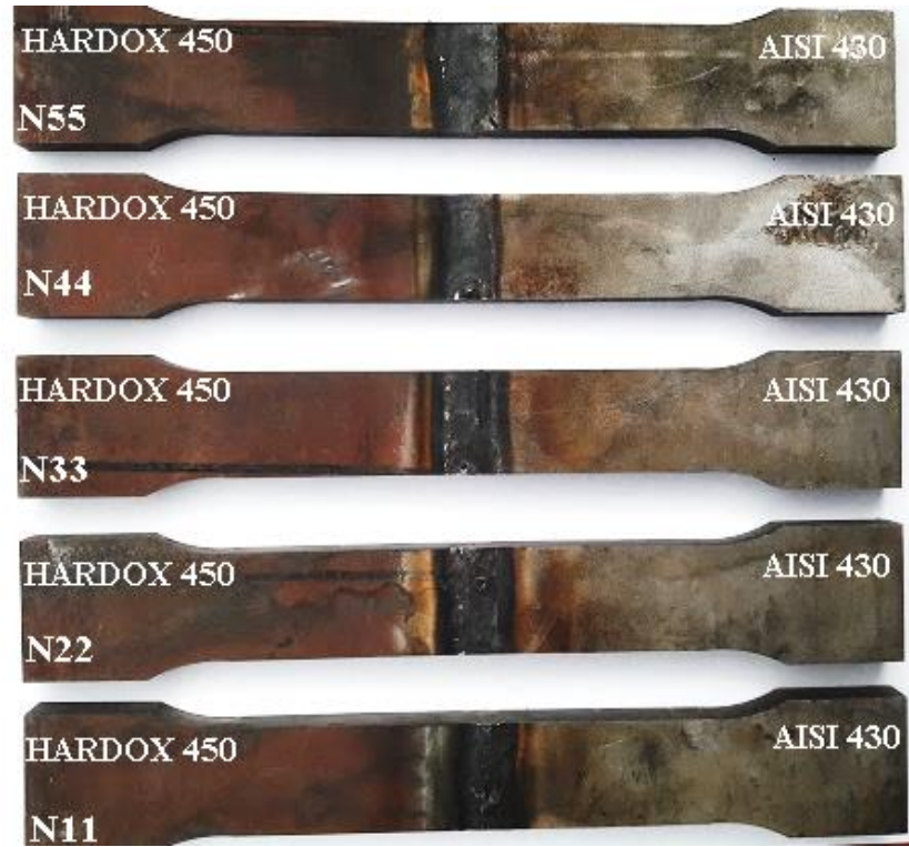
Şekil 4.118 Ara tabakalı numunelerin çekme deneyi öncesi makro görünüşleri
