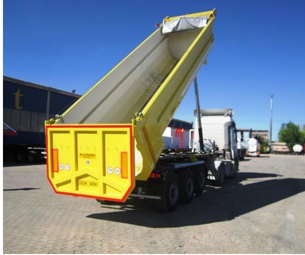
Şekil 1.26 HARDOX çeliğinden yapılmış bir kamyon kasası [34]
