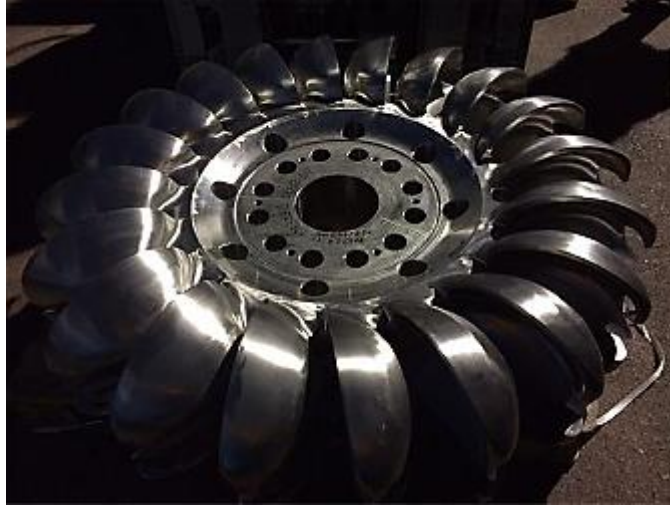
Şekil 1.21 Ferritik paslanmaz çelikten imal edilmiş HES türbini [20]
