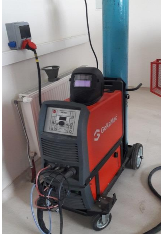
Şekil 3.3 TIG kaynak makinesi
