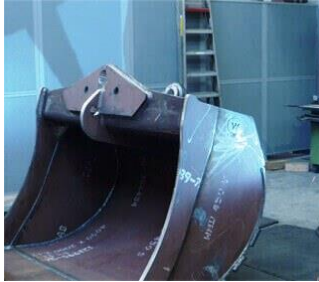
Şekil 1.23 HARDOX çeliğinden yapılmış dozer kepçesi [30]
