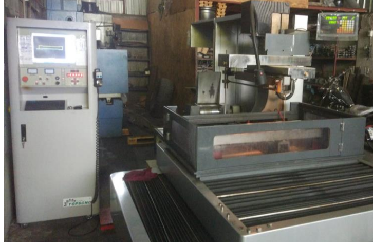
Şekil 3.12 Tel erozyon kesme makinesi
