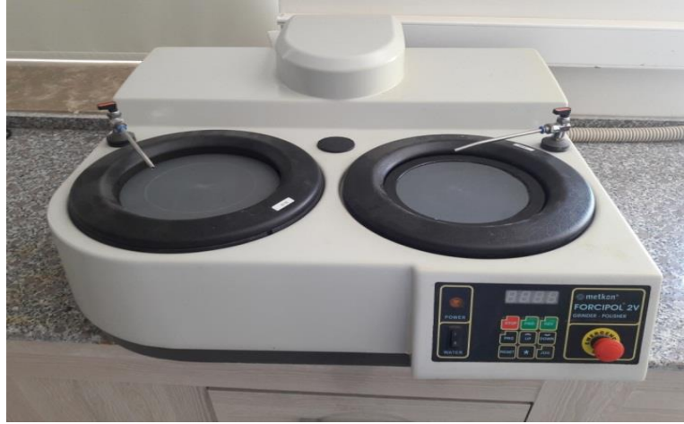
Şekil 3.5 Metalografik numuneleri zımparalama ve parlatma makinesi
