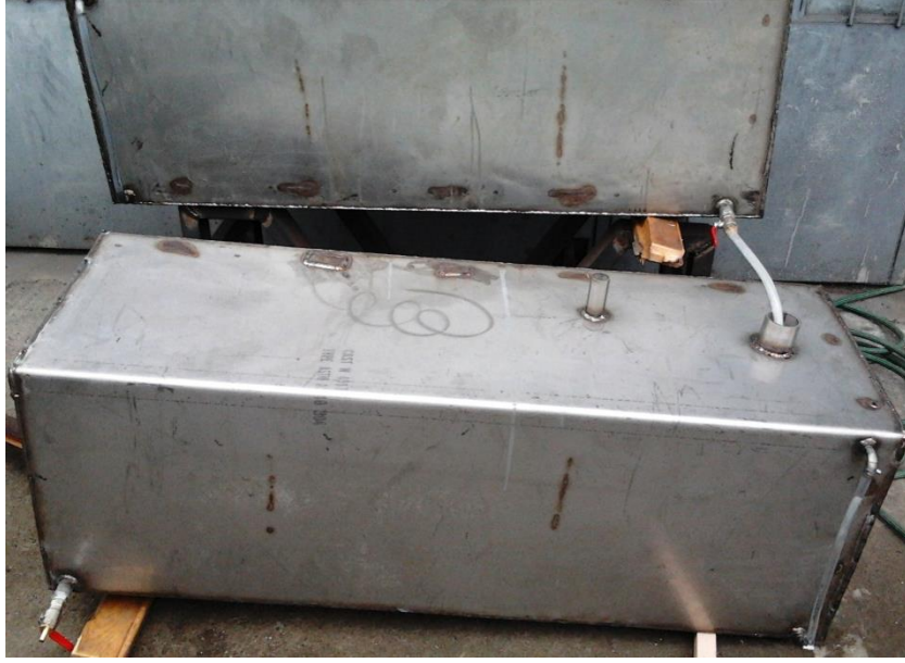
Şekil 1.16 Paslanmaz çelikten imal edilmiş sıvı taşıyıcı depolar
