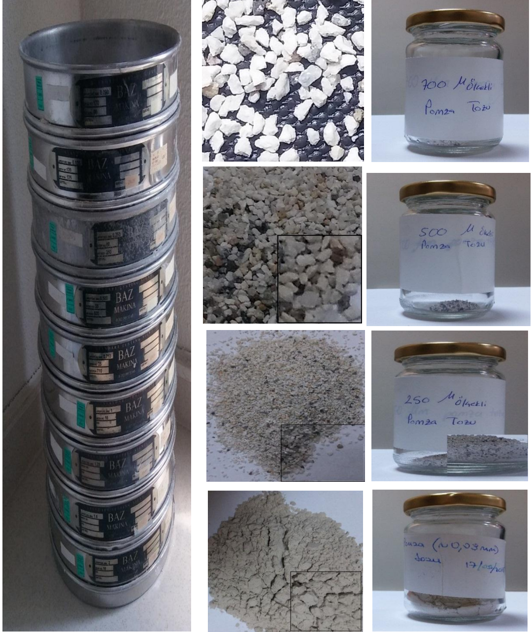
Resim 3.3 Karışımları farklı ölçüklere ayırmada kullanılan elekler ve mikronize hale getirilen 710 \mu , 500 \mu , 250 \mu ve 90 \mu pomza tanecikleri
