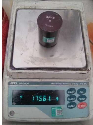
Resim 3.7 Hassas tartıda ölçülen Silikon esaslı dış cephe boyası
