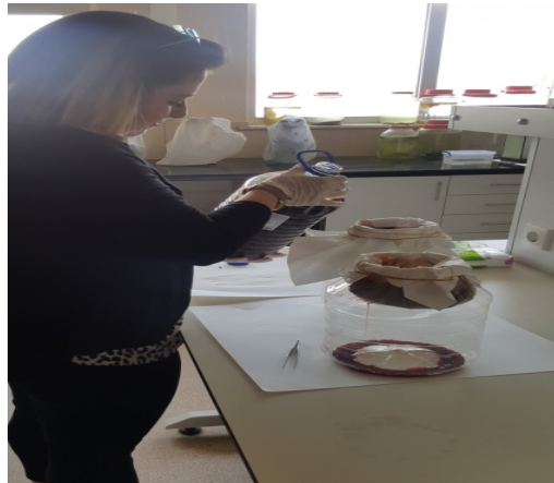
Resim 3.3 Mezbaaha atık suyunun kaba filtreleme işlemi
