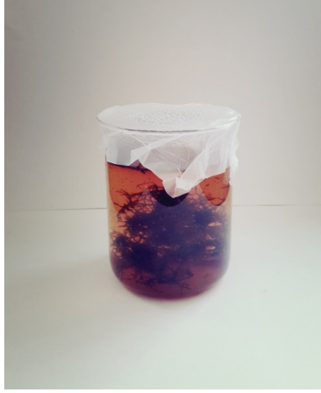
Resim 3.8 Makrofit ekimi yapılmış mezbaha atık suyu
