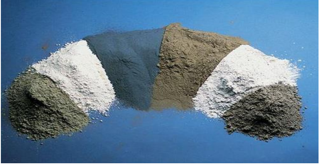
Resim 2.1 Puzolan Türleri; Sağdan Sola: Kalsine Edilmiş Şeyl, Yüksek Fırın Cürufu, F Sınıfı Uçucu Kül, Silis Dumanı, Metakaolin, C Sınıfı Uçucu Kül [22]
