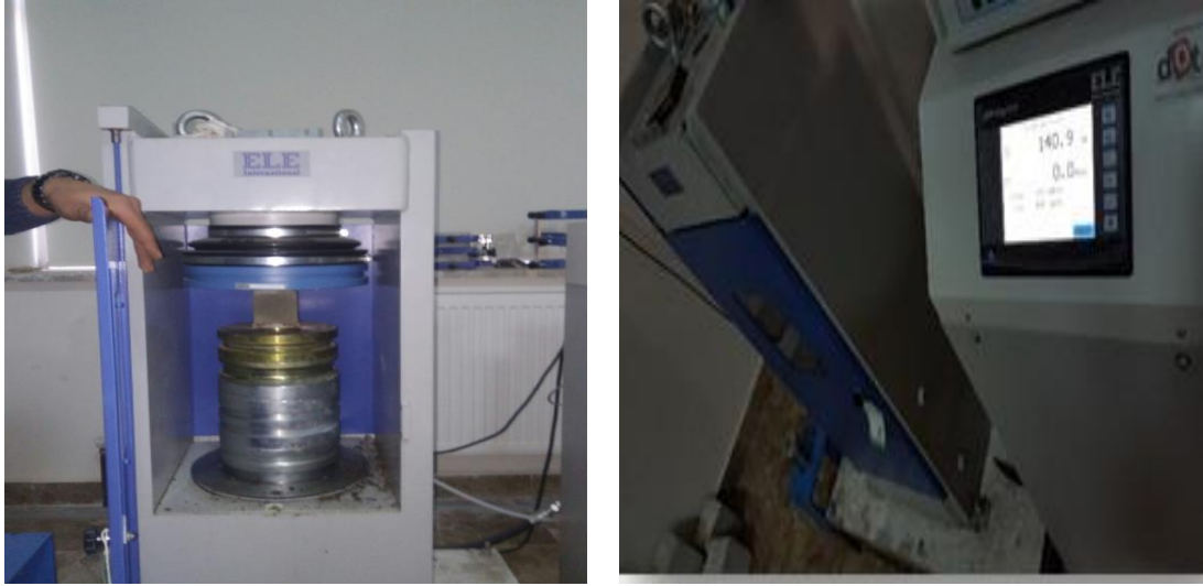
Resim 6.10 Beton Numunelerin Basınç Dayanımlarının Belirlenmesi
