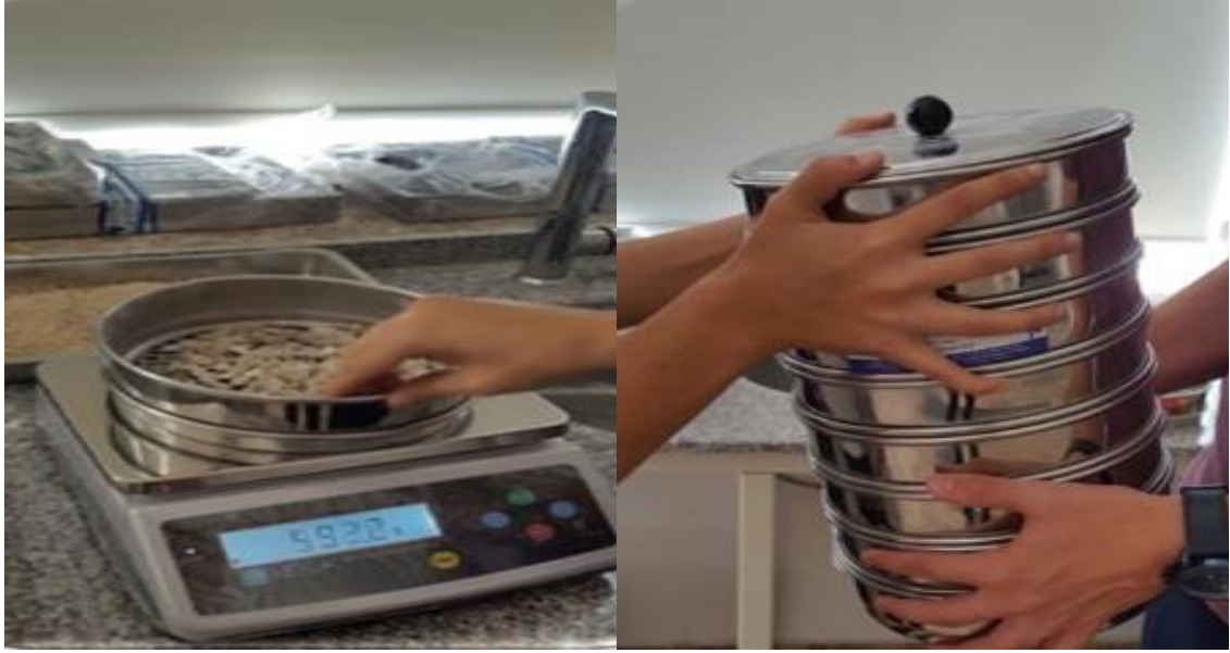
Resim 6.2 Eleme Analizi İçin Kullanılan Elekler ve Tartım İşlemi
