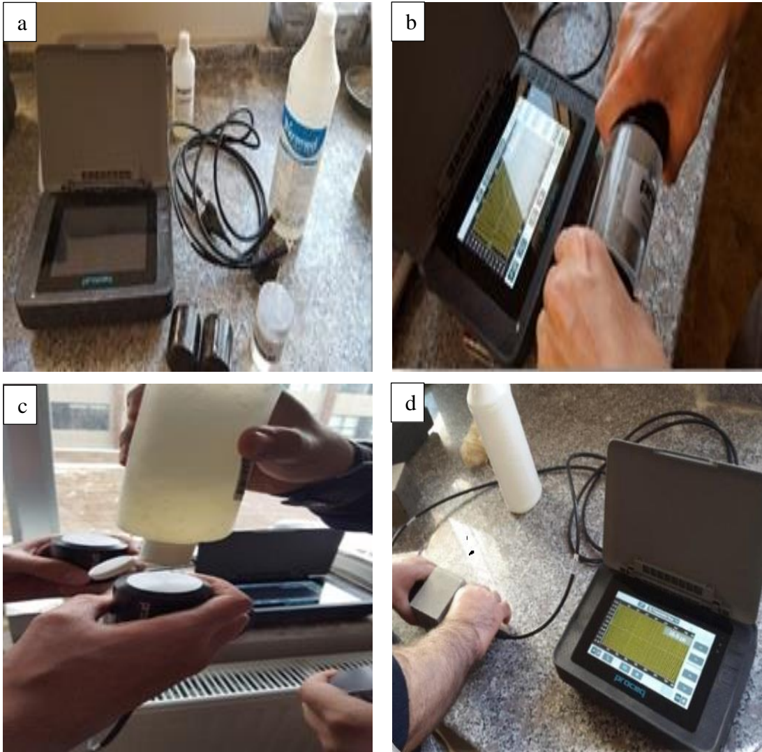
Resim 6.11 Beton Numunelerin Ultras ses Ölçümlerinin Yapılması
