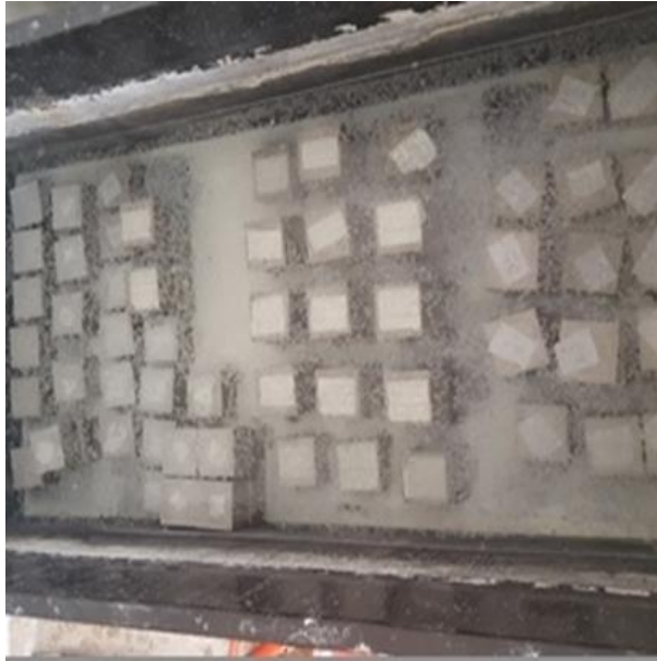
Resim 6.8 Beton numunelerin kür havuzunda kür edilmesi
