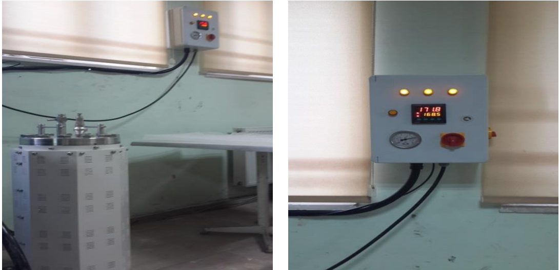
Resim 6.9 Beton numunelerin otoklav içerisinde kür edilmesi
