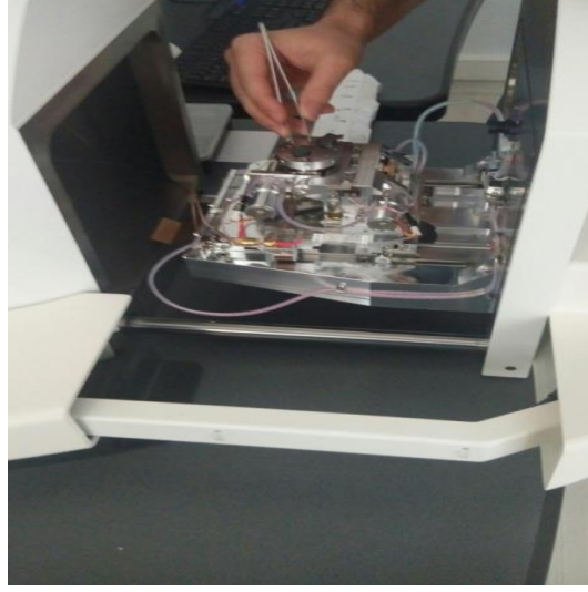
Resim 6.15 Numunelerin SEM Cihazına Yerleştirilme Anı
