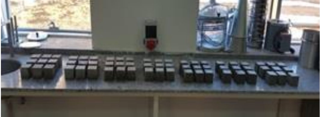
Resim 6.7 Hazırlanan Küp Numunelerin Kalıplardan Çıkarılması
