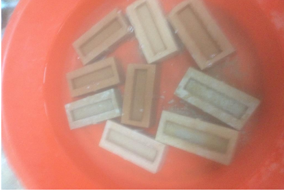
Resim 4.5 Pişirilen tuğlaların 24 saat suda bekletilmesi
