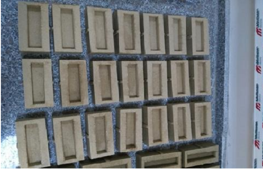
Resim 3.6 Oda sıcaklığında kurumaya bırakılan ham tuğlalar
