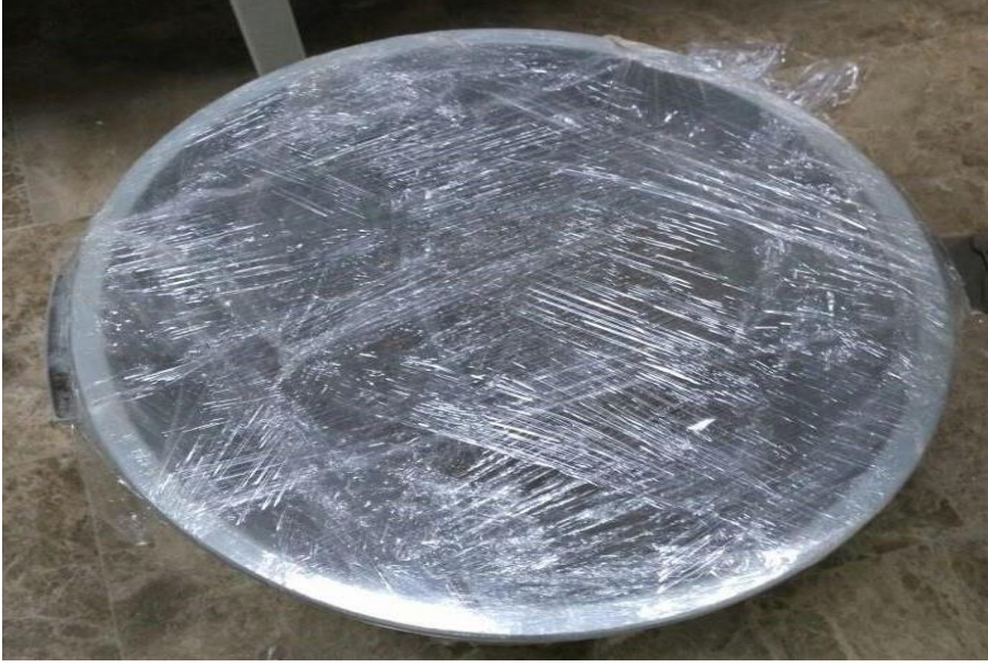
Resim 3.3 Tuğla hamurunun 24 saat hava almayacak şekilde dinlendirilmesi
