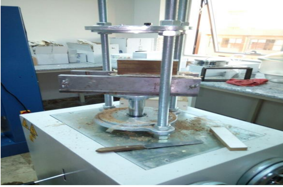
Resim 3.5 Hidrolik pres makinesinden ham tuğlanın çıkarılması
