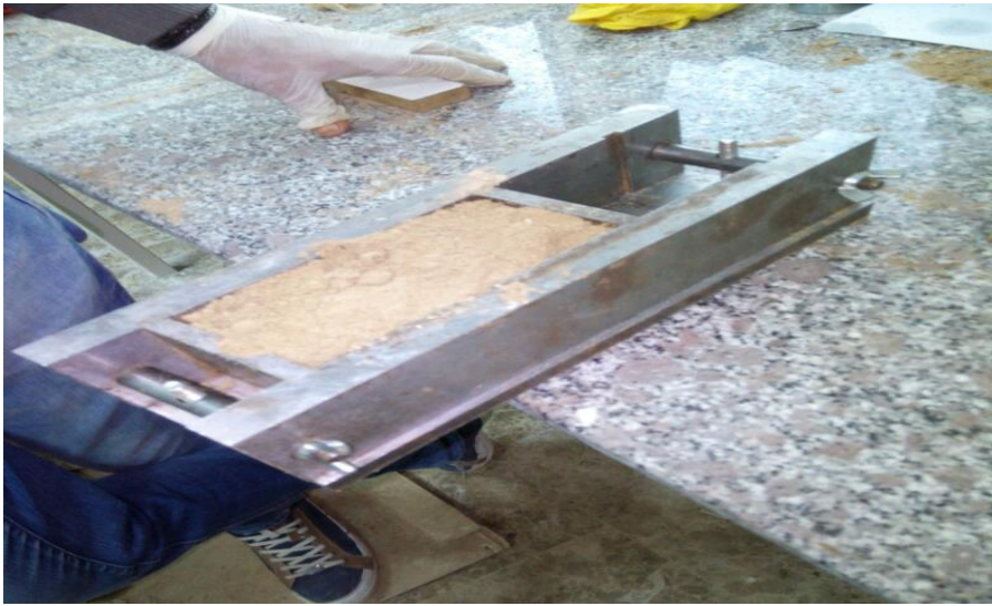
Resim 3.4 Çelik tuğla kalıbına toprağın dökülmesi
