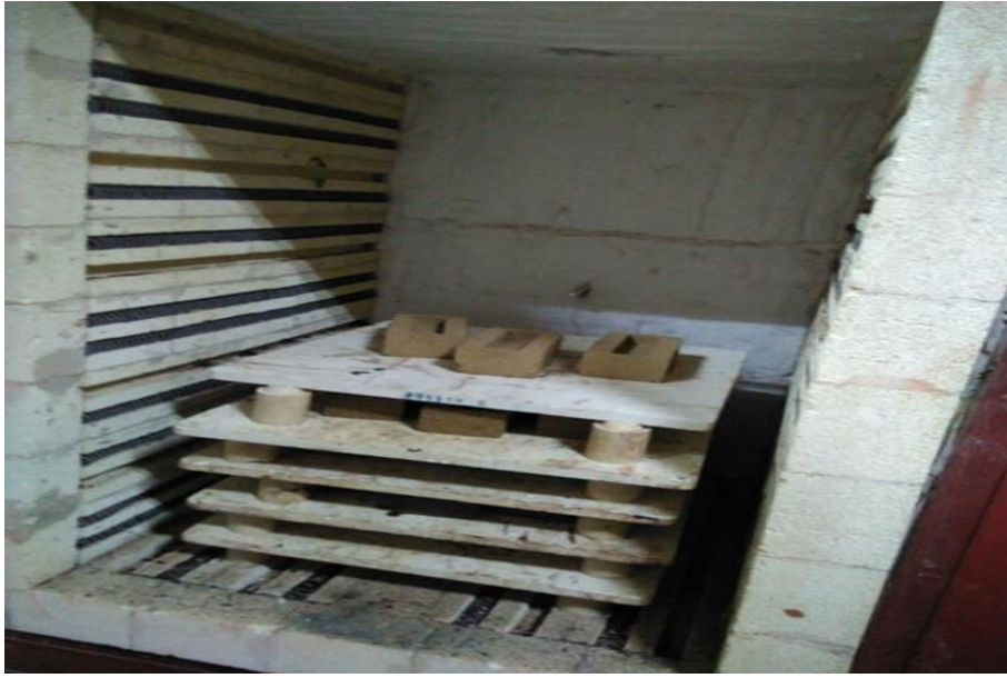
Resim 3.7 Tuğlaların yüksek fırına yerleştirilmesi
