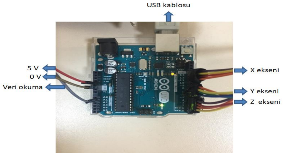
Resim 3.6 Adım motorları ve manyetik alan sensörünü denetleyen Arduino UNO mikro işlemcisi
