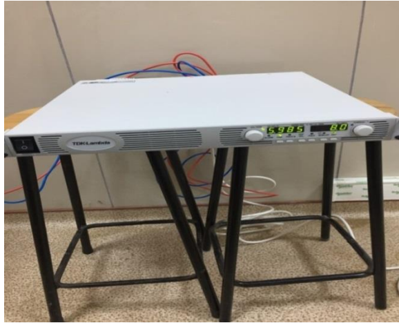
Resim 3.2 Selenoid elektromıknatısa akım veren DC ayarlı güç kaynağı
