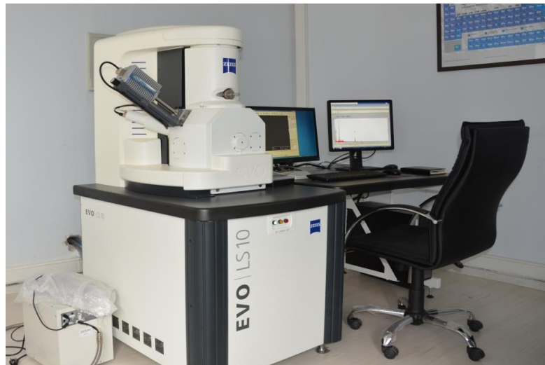
Şekil 3.7 Deneylerde kullanılan taramalı elektron mikroskobu (SEM)
