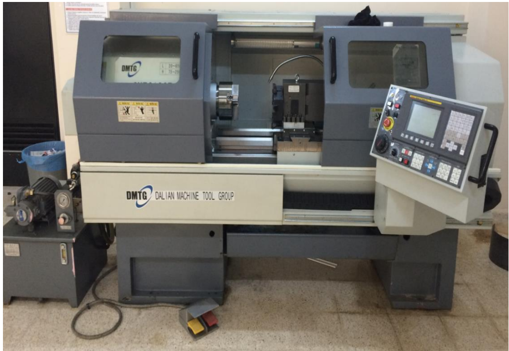
Şekil 3.1 Tornalamada kullanılan bilgisayar kontrollü CNC torna tezgâhı
