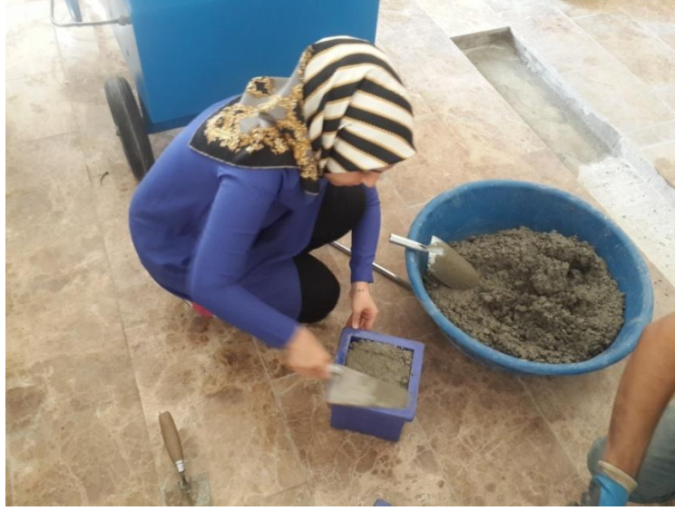
Resim 4.7 Beton numunelerinin kalıplara doldurulması
