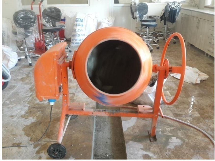
Resim 4.5 Beton üretim çalışmalarında kullanılan beton mikseri
