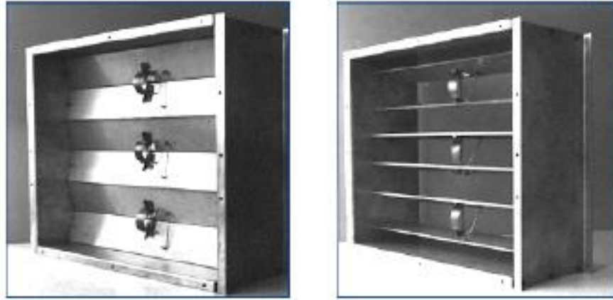
Resim 5.2 Ortam sıcaklığına göre açılıp kapanan sera pencere sistemi [16]
