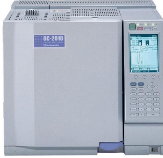
Resim 2.9 Shimadzu GC-2010 gaz kromotografi cihazı
