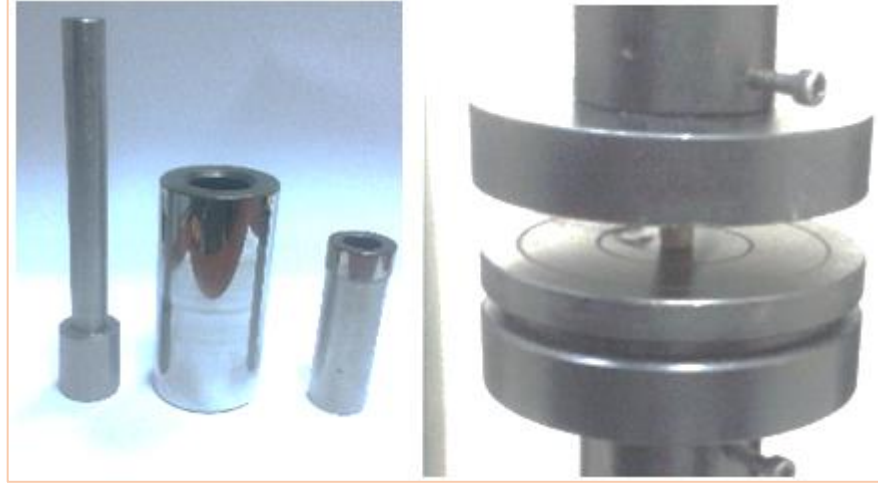
Şekil 3.8. Basma testi cihazı ve tozlar için kullanılan kalıp görüntüleri
