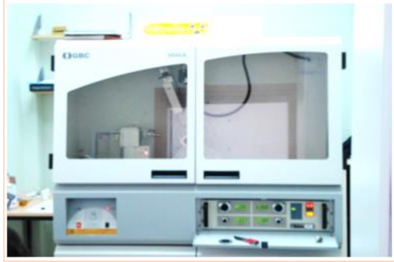
Şekil 3.7. X-ışını kırınım ölçümü için kullanılan XRD cihazı görüntüsü
