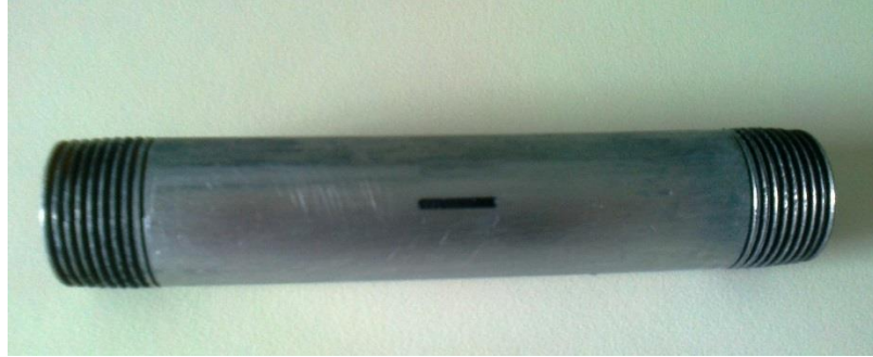
Resim 3.1 Üzerine çatlak oluşturulmuş galvanizli boru
