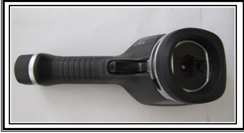
Şekil 3.5 Çalışmada kullanılan termal kameranın görünümü
