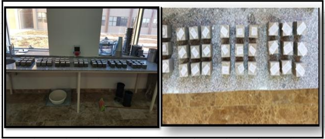
Şekil 3.8 SD,UK ve YFC Katkılı 7x7x7 cm küp numuneler
