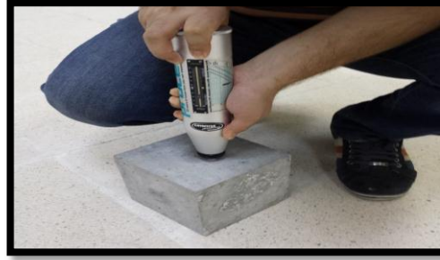
Şekil 3.13 Sertleşmiş betonda Schmidt çekici ile beton yüzey sertliği ölçümü
