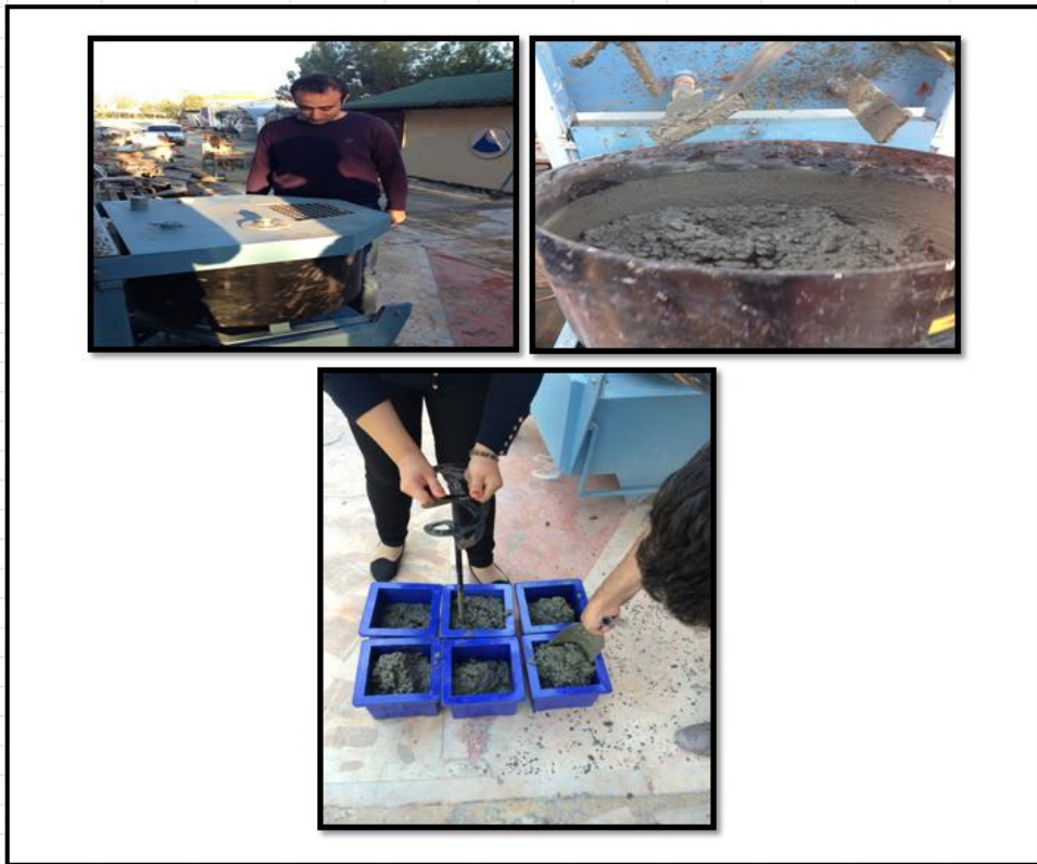
Şekil 3.7 Beton döküm aşamaları.
