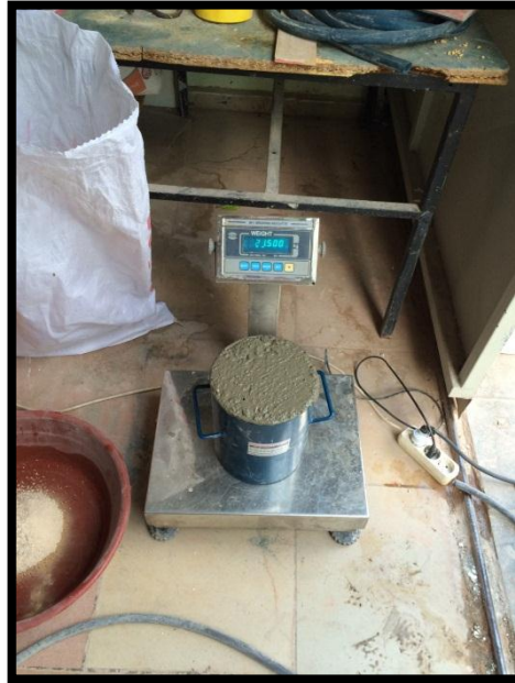
Şekil 3.10 Beton birim ağırlığının belirlenmesi
