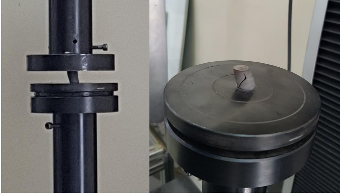
Şekil 5.8. Ti-16Nb-4Sn alaşımdan üretilen bir numunenin basma deneyi sırasında ve sonrasında görüntüsü
