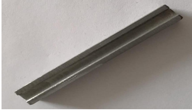
Şekil 2.1. AISI1020 çeliğinin kaplama öncesi resmi
