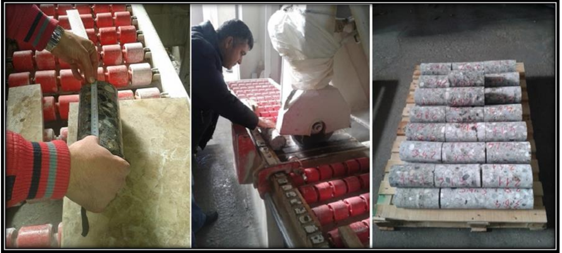
Şekil 4.11. Adıyaman Mermer fabrikasında karot numunelerinin ölçülerek başlık kesimi
