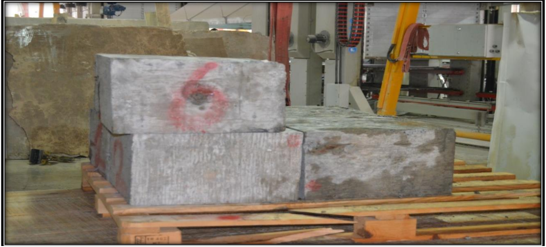
Şekil 4.7. 40x40x25 cm boyutlarına kesilen beton numuneleri
