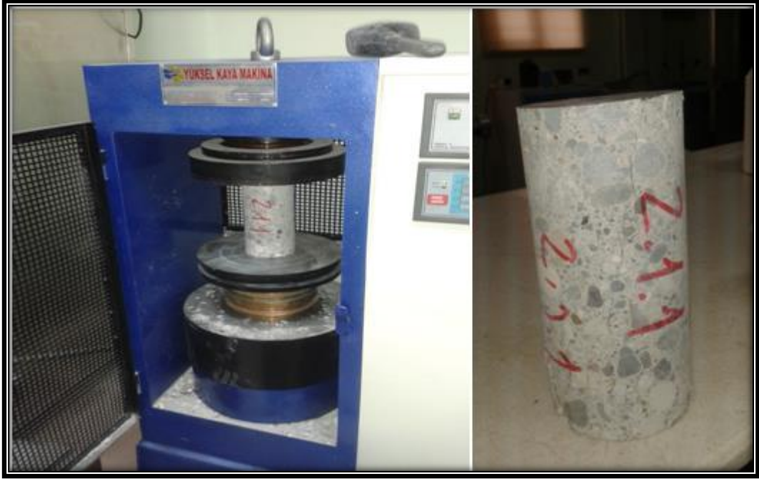
Şekil 4.14. Karot numunelerine uygulanan basınç deneyi
