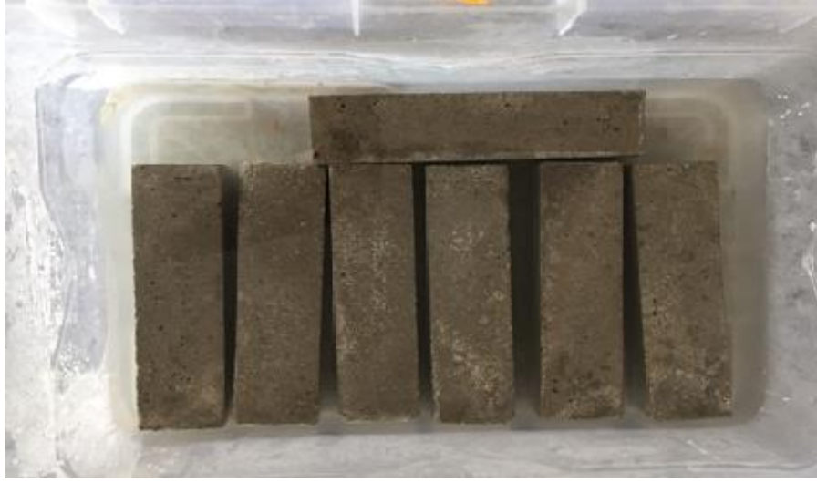
Resim 3.12 Numunelerin çözelti içinde bekletilmesi
