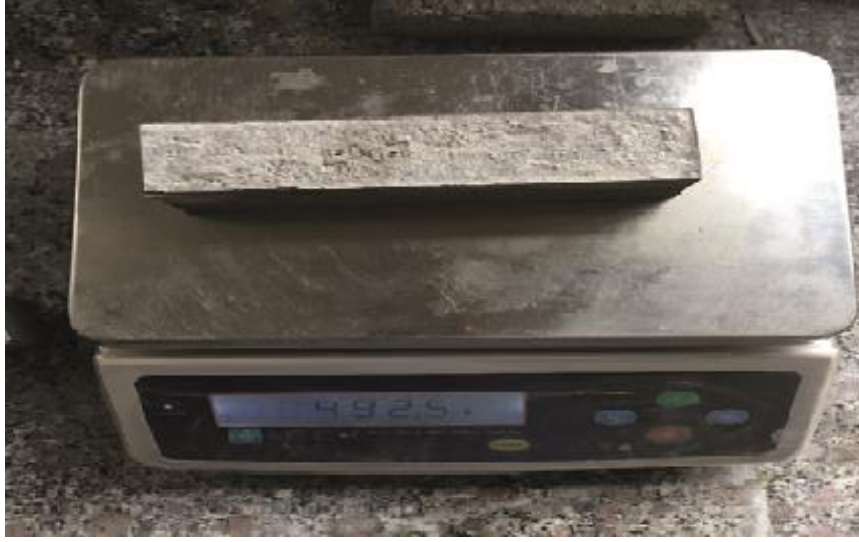
Resim 3.11 Deney öncesi numunenin tartılması
