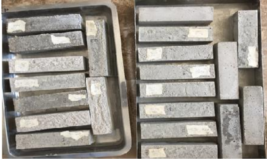
Resim 3.13 Çözeltiden çıkarılan numunelerin bekletilmesi
