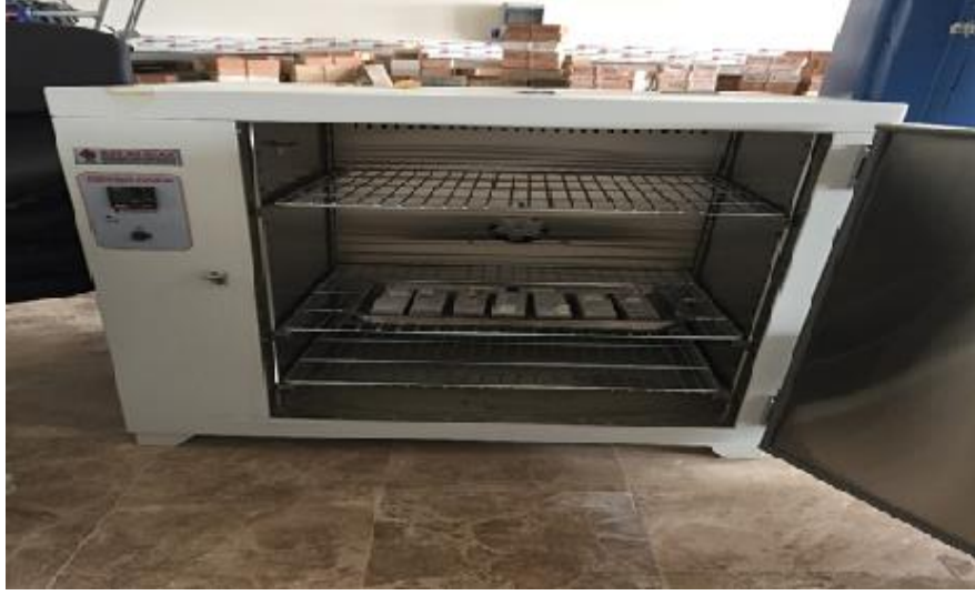
Resim 3.14 Numunelerin etüve konulması
