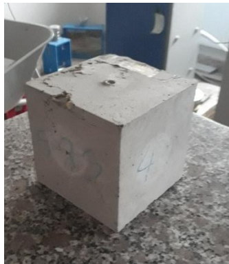
Resim 6.2 %5 kazınmış asfalt içerikli numunenin basınç deneyi sonrası oluşan hasar
