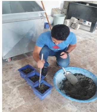
Resim 5.7 Çalışma sonucunda üretilen taze betonun şişlenip sıkıştırılması
