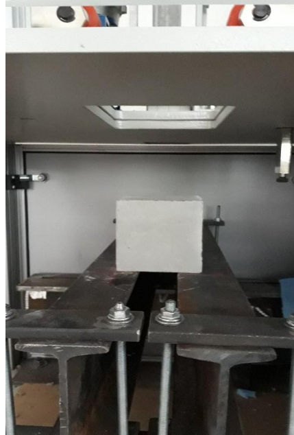
Resim 5.18 Küp numunenin ağırlık düşürme cihazına yerleştirilmesi
