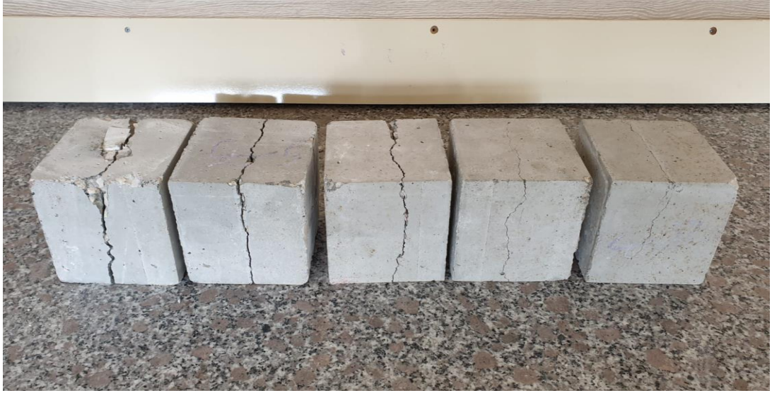
Resim 6.8 75 °C ortam sıcaklığında deneye tabi küp numunelerdeki ağırlık düşürme sonrası hasar (sol başta kontrol numunesi olmak üzere sağa doğru kam oranının artması sonucunda oluşan değişim)
