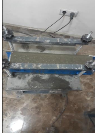
Resim 5.9 Kiriş numunenin vibrasyon masasında sıkıştırılması
