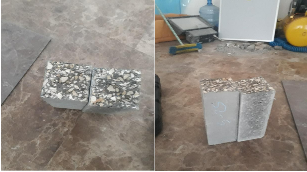
Resim 5.17 Ağırlık düşürme sonucunda kırılan kiriş
