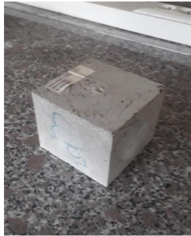
Resim 6.5 %20 kazınmış asfalt içerikli numunenin basınç deneyi sonrası oluşan hasar
