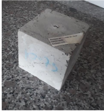
Resim 6.3 %10 kazınmış asfalt içerikli numunenin basınç deneyi sonrası oluşan hasar
