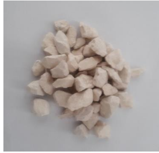
Resim 5.1 Karışımlarda kullanılan 11.2-22.4 mm kırmataş
