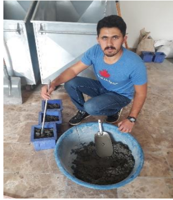
Resim 5.6 Çalışmalarda üretilen taze betonun kalıplara yerleştirilmesi
