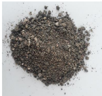
Resim 5.3 Karışımlarda kullanılan 0-4 mm kum
