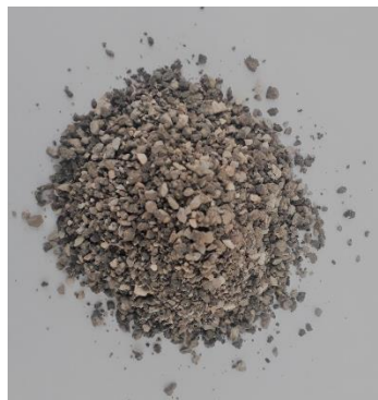
Resim 5.4 Beton karışımlarında kullanılan 0-4 mm kazınmış asfalt malzeme
