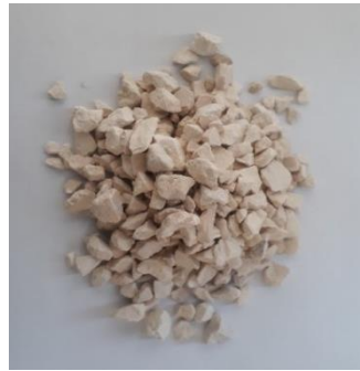
Resim 5.2 Karışımlarda kullanılan 4-11.2 mm kırmataş
