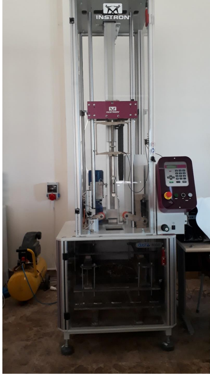
Resim 5.15 Deneylerde kullanılan ağırlık düşürme test cihazı
