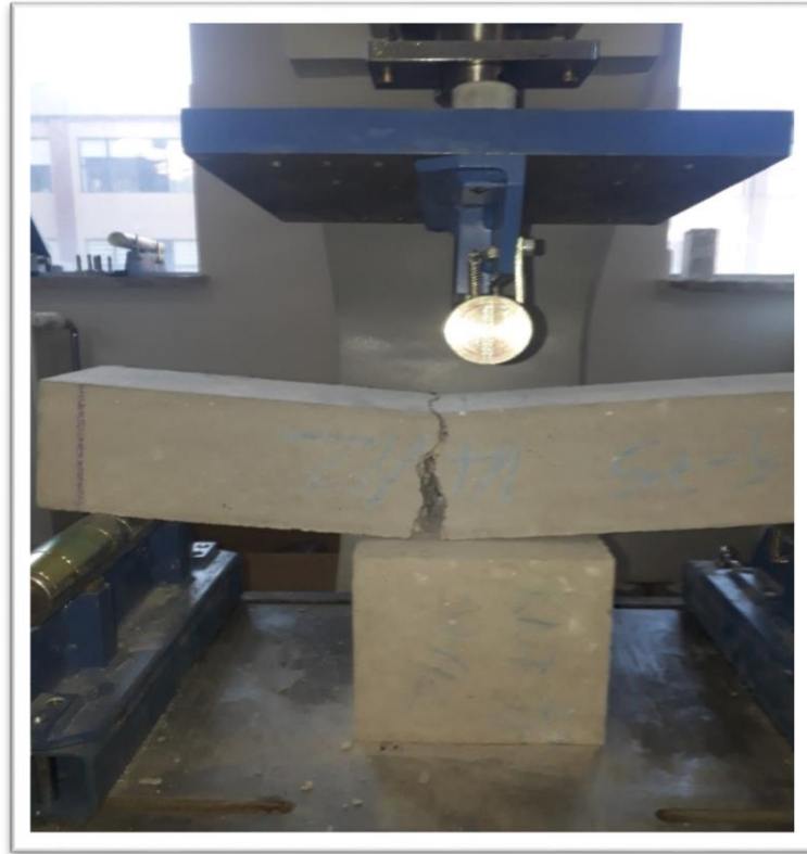
Resim 5.14 Eğilmede çekme deneyi sonrası
