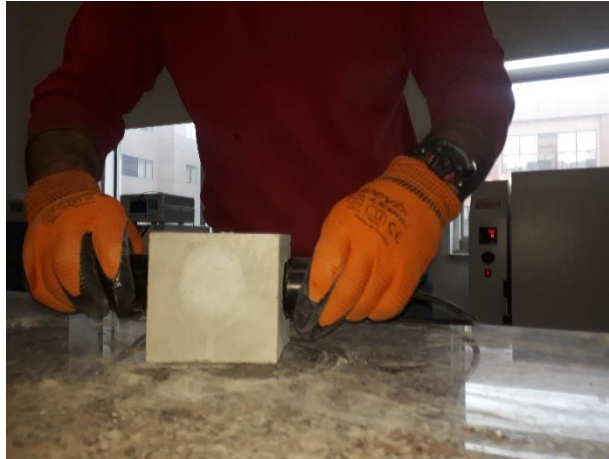
Resim 5.12 Küp numunelerde ultra ses deneyi
