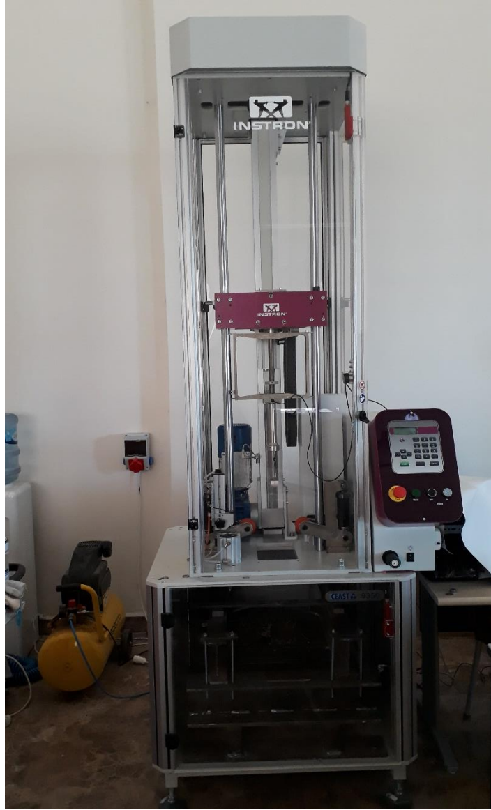
Resim 4.1 Deneylerde kullanılan ağırlık düşürme test cihazı
