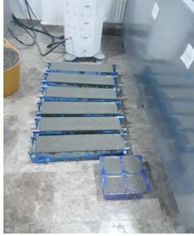
Resim 5.10 Günlük planlanan çalışmaları sonucunda üretilen küp ve kiriş numune betonlar
