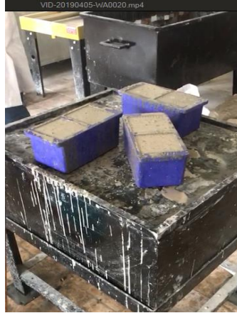
Resim 5.8 Beton numunelerinin vibrasyon masasında sıkıştırılması
