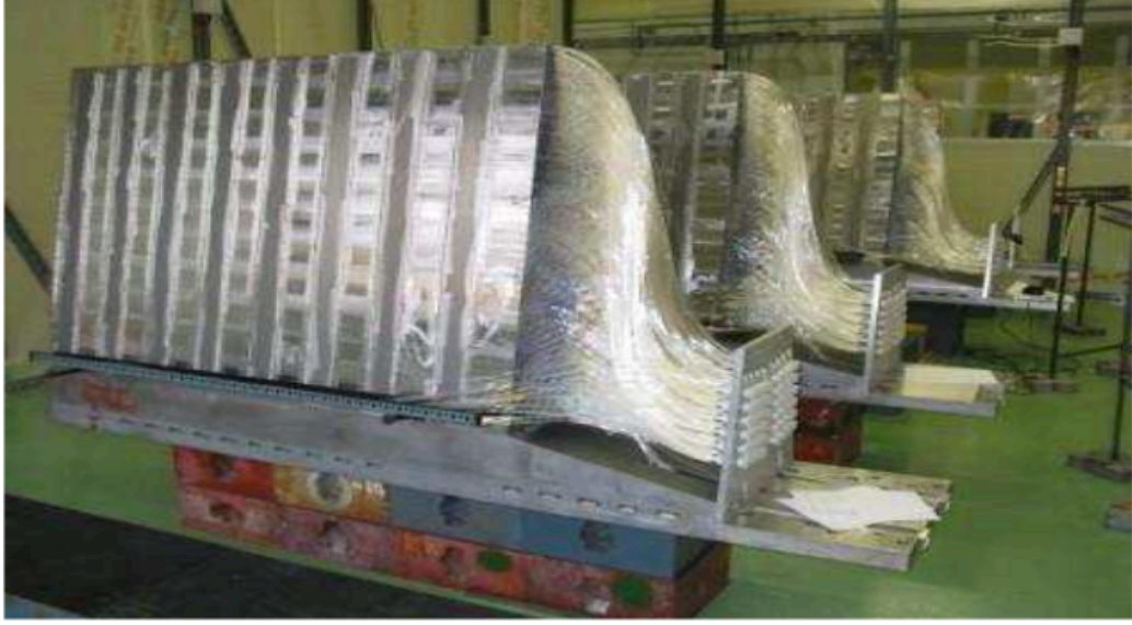
Őekil 3.20. HF kalorimetresinde yer alan elik kamalar ve kuvartz fiberler (Penzo ve ark. 2009)
