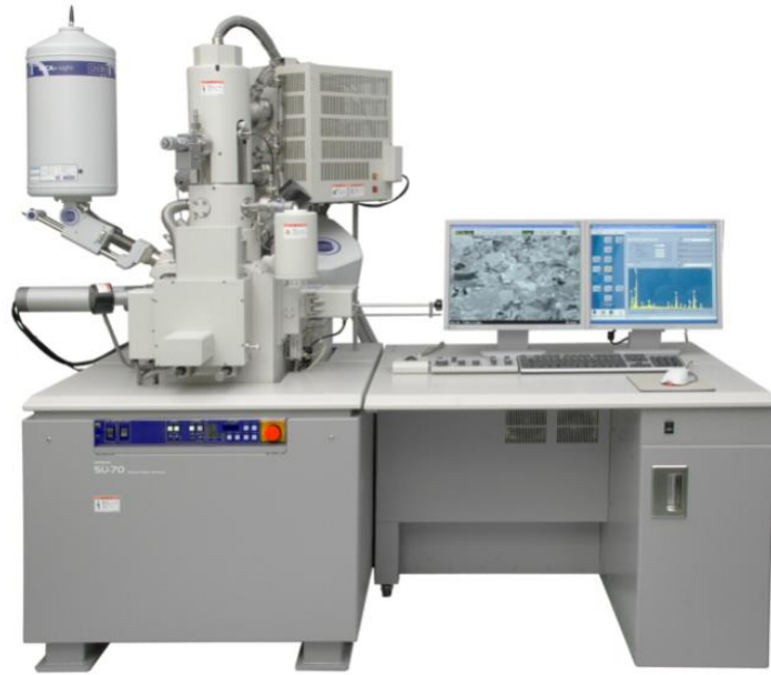
Şekil 3.4.2.1. Taramalı Elektron Mikroskobu (SEM) ve Enerji Dağılımlı X-ışını (EDX) mikro analizi.
