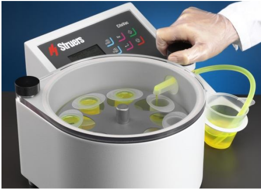
Şekil 3.29. Kalıp kutularına epoksi akıtılması
