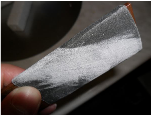
Şekil 3.33. Demir levhaya sarılmış zımpara kâğıdıyla kalıp kenarlarının zımparalanması
