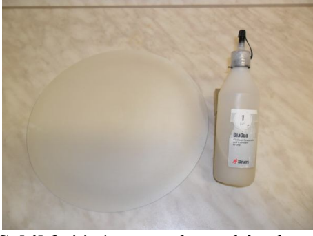
Şekil 3.44. 1 µm parlatma kâğıdı ve 1 µm parlatma sıvısı
