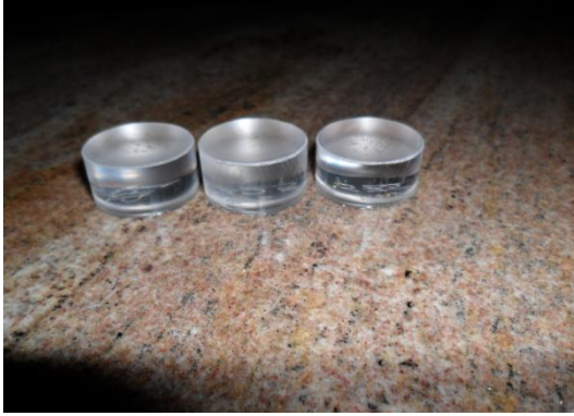
Şekil 3.34. Kenarları zımpara edilmiş numuneler
