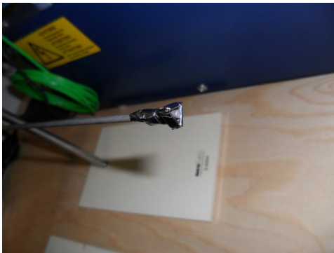
Şekil 3.21. Sensörün ucuna yerleştirilen titanit minerali ile dolu zarflar
