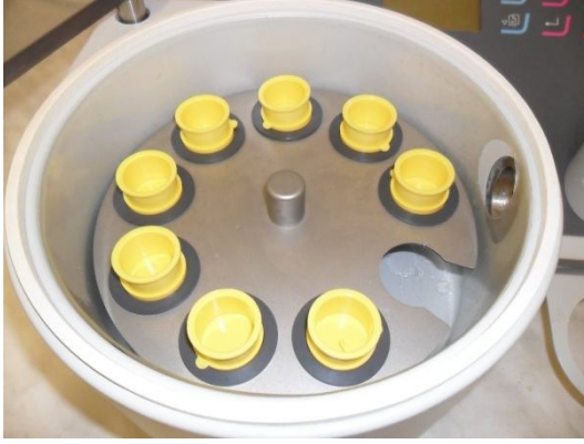
Şekil 3.28. CitoVac cihazına yerleştirilen kalıp kutuları
