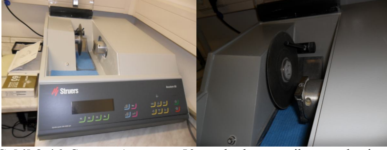
Şekil 3.46. Struers Accutom-50 marka kesme cihazı ve kesim zımparası
